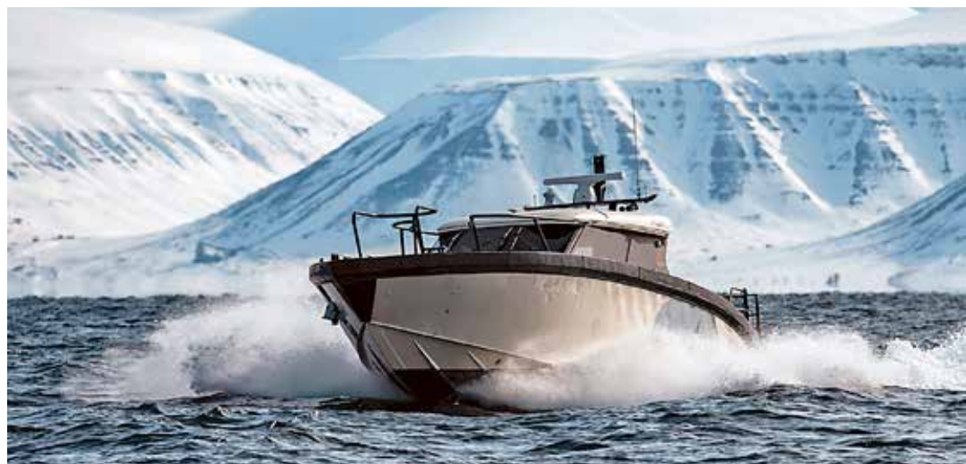
Volvo Penta, Marell Boats och Hurtigruten Svalbard har testat båtar med elhybriddrift. Volvo Penta står för motoriseringen och Marell Boats för båten. Motoriseringen består av Volvo Penta dubbla D4-320 DPI Aquamatic dieselmotorer i en hybridinstallation. Båten har en toppfart på 30 knop och en marschfart på 24 knop. Räckvidden anges till 500 Nm.
