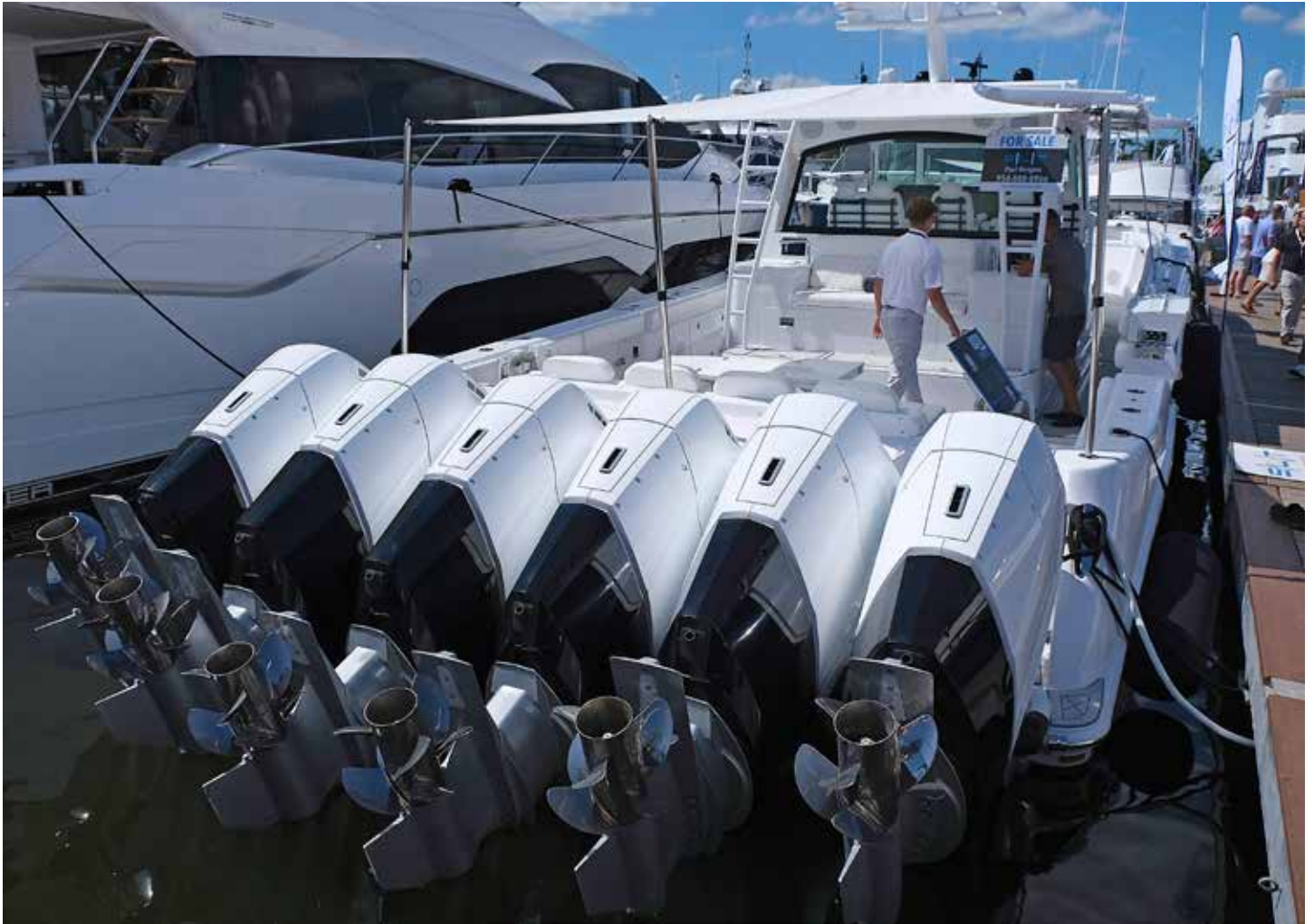
Sex Mercury V12 à 600 hk på akterspegeln är inte en särskilt vanlig syn ens i Florida. Denna HCB 65 Estrella är topputrustad och har förutom de rejäla motorerna bland annat Seakeeper 9, undervattenskameror, 25 kW radar, vattenmaskin med mera. Pris 48 Mkr.
