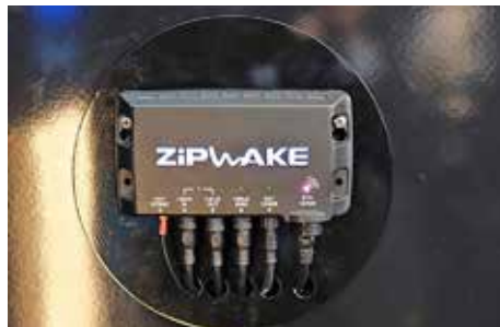
Zipwake visade sin nya Integrator Module. Kontrollpanelen för interceptorsystemet finns kvar, men informationen finns visas med den nya enheten även i båtens multifunktionsskärmar via en Ethernetkabel. På METS var det uppkopplat med skärmar från Garmin, Simrad och Raymarine.
