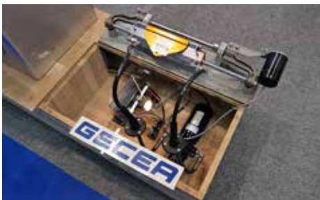
Gecea visade sin nya elhydrauliska styrning som hanteras via en sensor vid ratten och så styrs enheten via en elektrisk kabel till en styrenhet som i sin tur styr hydropumpen. Det krävs därför inga hydrauliska slangar upp till ratten. Styrningen är avsedd för utombordare upp till cirka 300 hk och går att bygga ihop med Geceas system för gas och växel.
