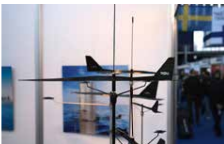
Original Windex har tillverkats i över två miljoner exemplar sedan 1972. Den har nu uppdaterats med en modernare version med infälld motvikt och kolfiberspinne som ersätter den tidigare modellen i mitten av 2023.
