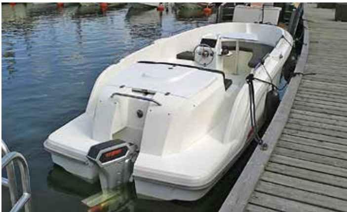
Dahl E660 är en picknic-båt på 6 m, som visar att man kan göra en ganska enkel motorinstallation om man nöjer sig med farter på upp till 8 knop. Utrustas med en Torqeedo Cruise 10.0 (13,6 hk) och två batterier på sammanlagt 10 kWh. Driftstid vid 5 knop cirka 6 timmar, 8 knop cirka 2 timmar.
