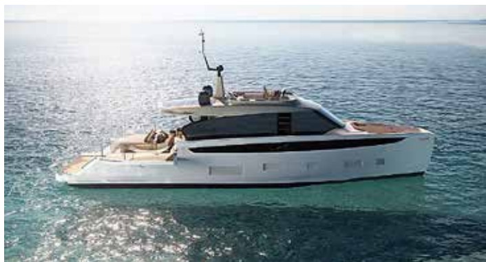
Azimut Seadeck är en ny serie hybridmotoryachter från Azimut. Tack vare nya tekniska lösningar ska båten minska utsläppen med upp till 40 procent. Motorerna är tre Volvo Penta IPS dieselmotorer på 380 respektive 480 hk beroende på effektval med hybriddrift. På bilden Seadeck 7.
