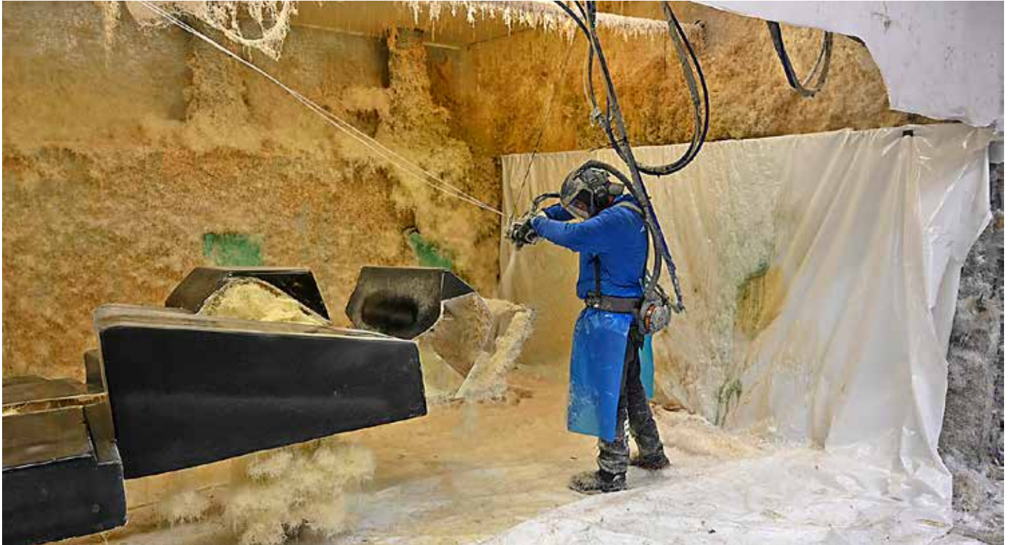
Tillverkningen sker med traditionell sprutning och handuppläggning av plast och glas.
