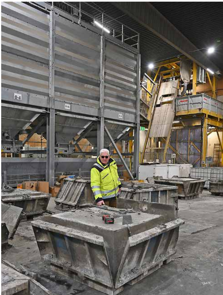
Bryggorna tillverkas inomhus i stora formar i en stor fastighet, där SF Pontona även har egen tillverkning av betong.
