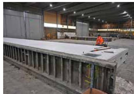
Bryggorna tillverkas inomhus i stora formar i en stor fastighet, där SF Pontona även har egen tillverkning av betong.
